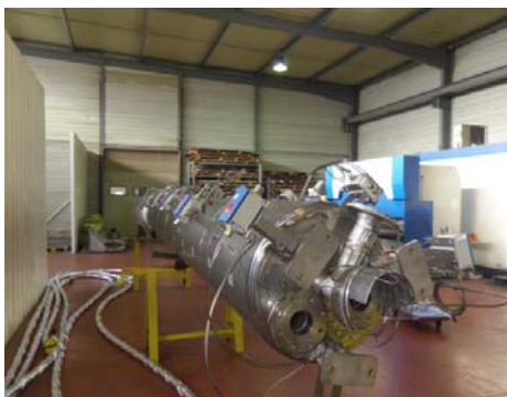
Photo : Puits de chauffe monté - CLM
